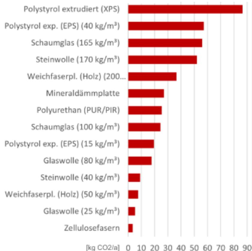
Abb. 6. Treibhauseffekt bei U-Wert von 0.17 W/m²K [kg CO2/a]
